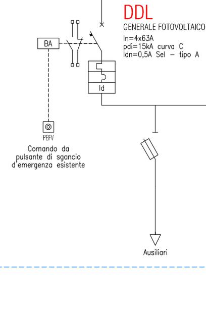
**QAC - QUADRO INVERTER LATO C.A. - SCHEMA MULTIFILARE PROTEZIONE DI INTERFACCIA**
