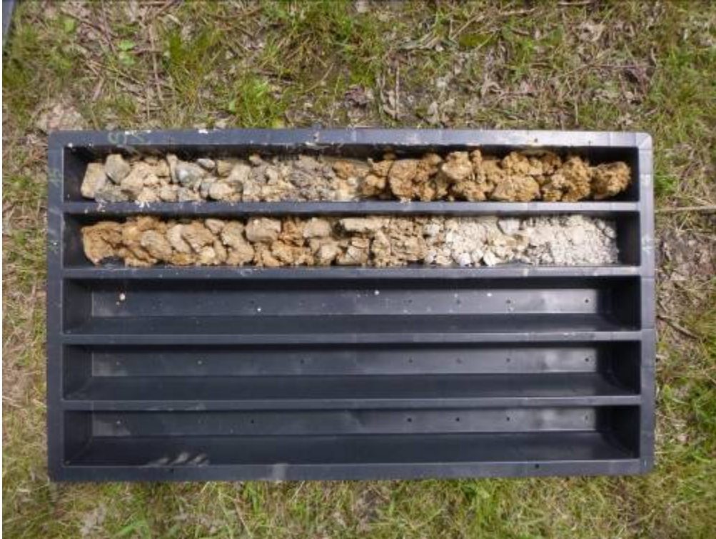
S 2 Carotaggio da -15.00 a -17.00 m dal p.c.
