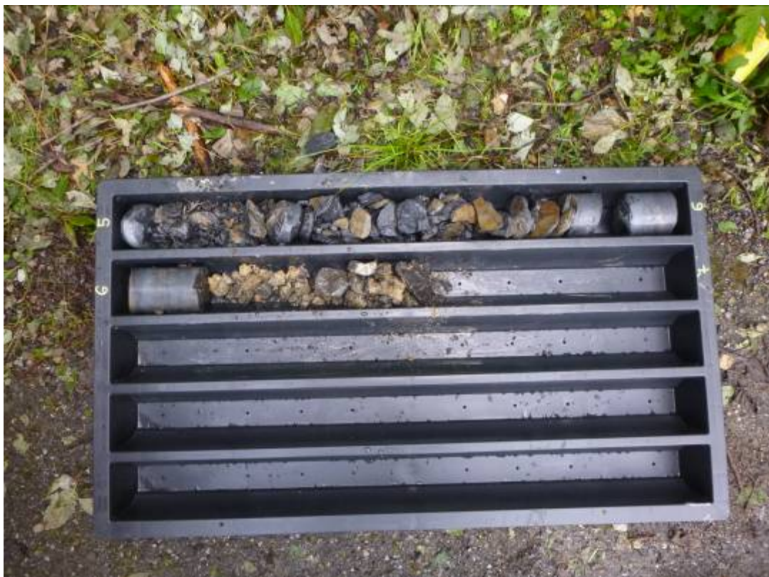
S 3 Carotaggio da -5.00 a -7.00 m dal p.c
