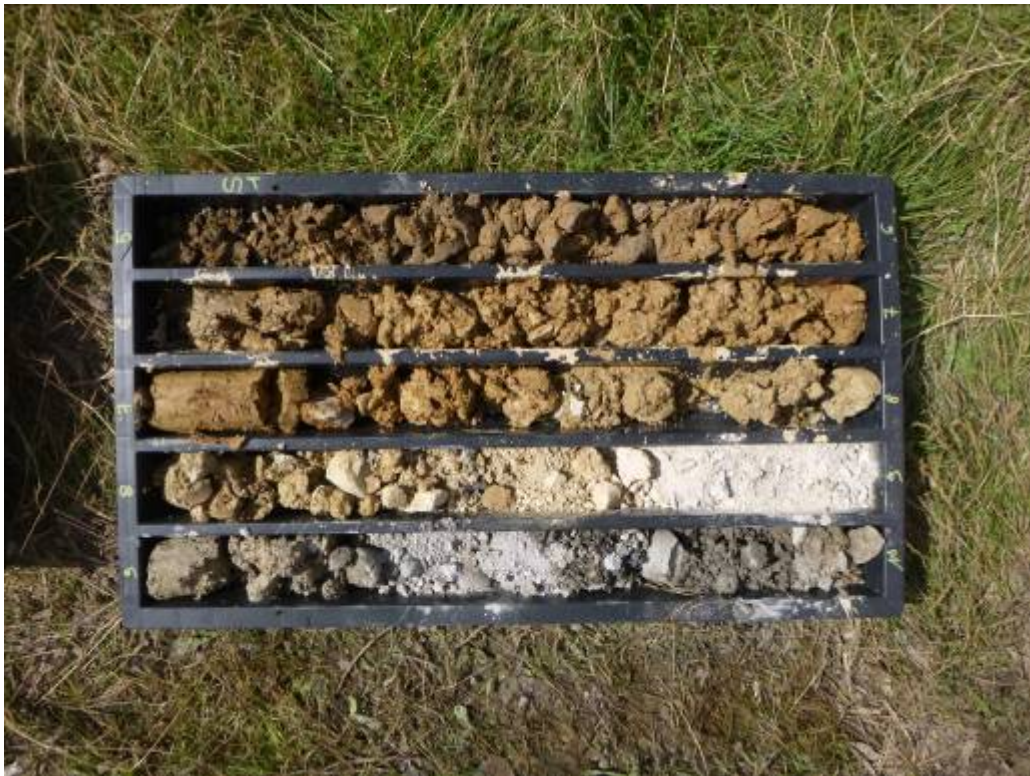
S 1 Carotaggio da -5.00 a -10.00 m dal p.c.
