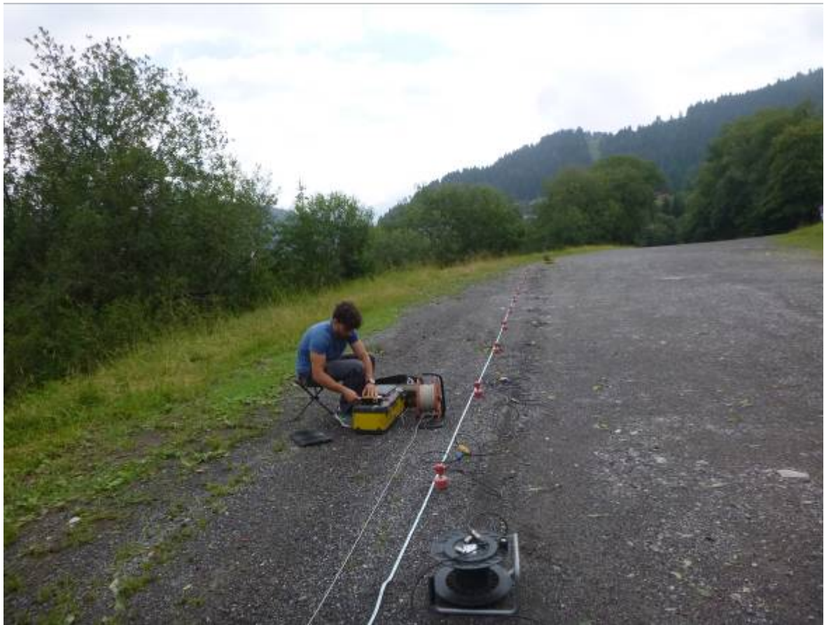
Stendimento di 24 geofoni sul parcheggio P3
