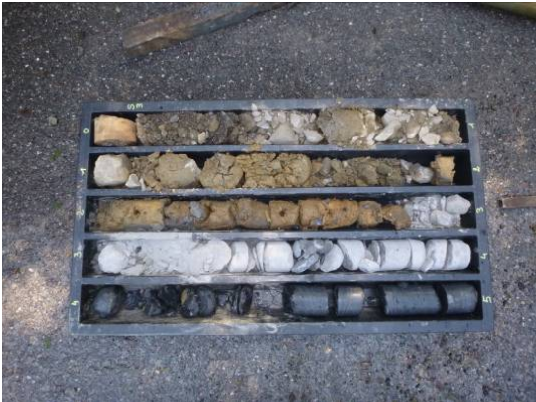
S 3 Carotaggio da -0.00 a -5.00 m dal p.c.
