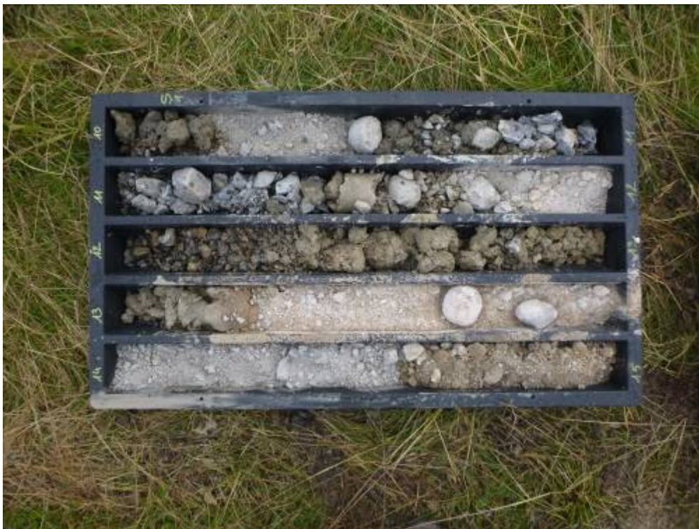
S 1 Carotaggio da -10.00 a -15.00 m dal p.c.
