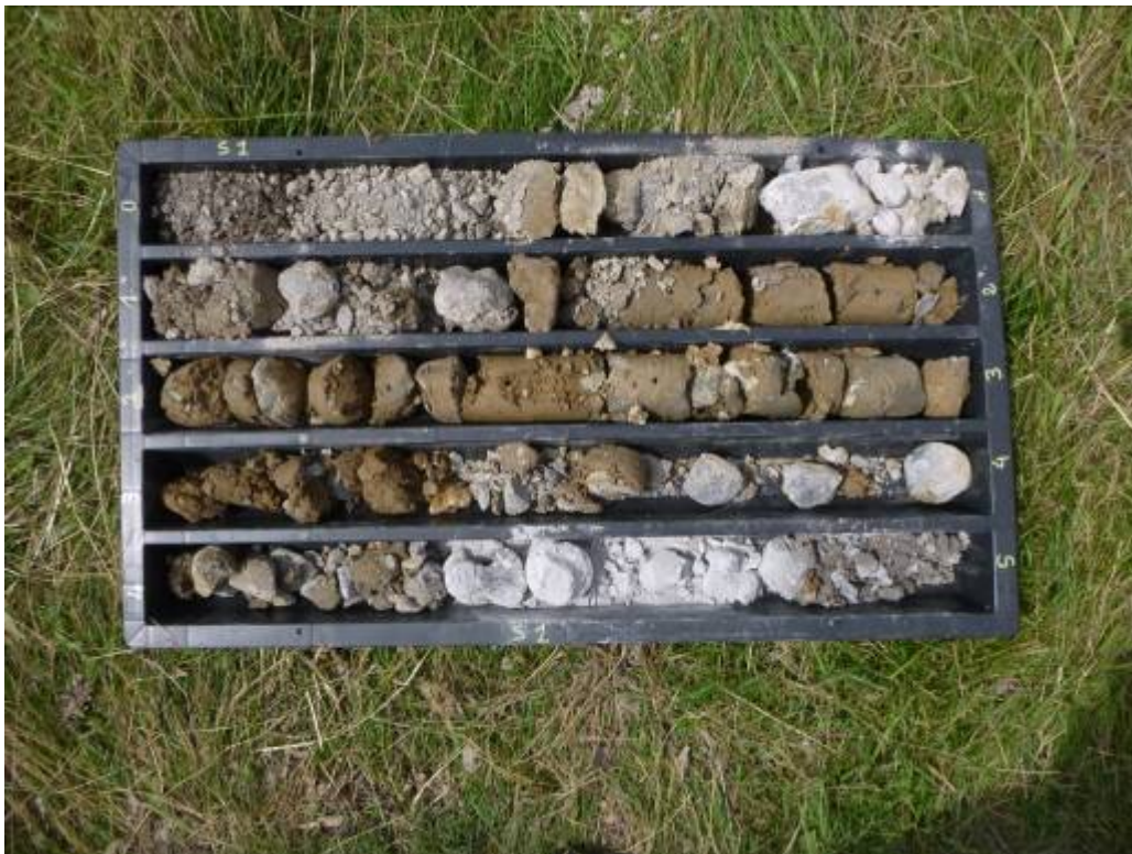
S 1 Carotaggio da 0.00 a -5.00 m dal p.c.
