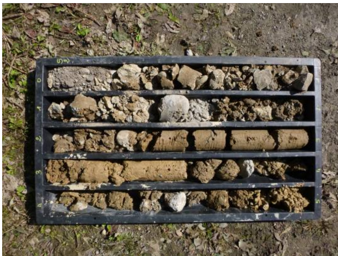
S 2 Carotaggio da 0.00 a -5.00 m dal p.c.
