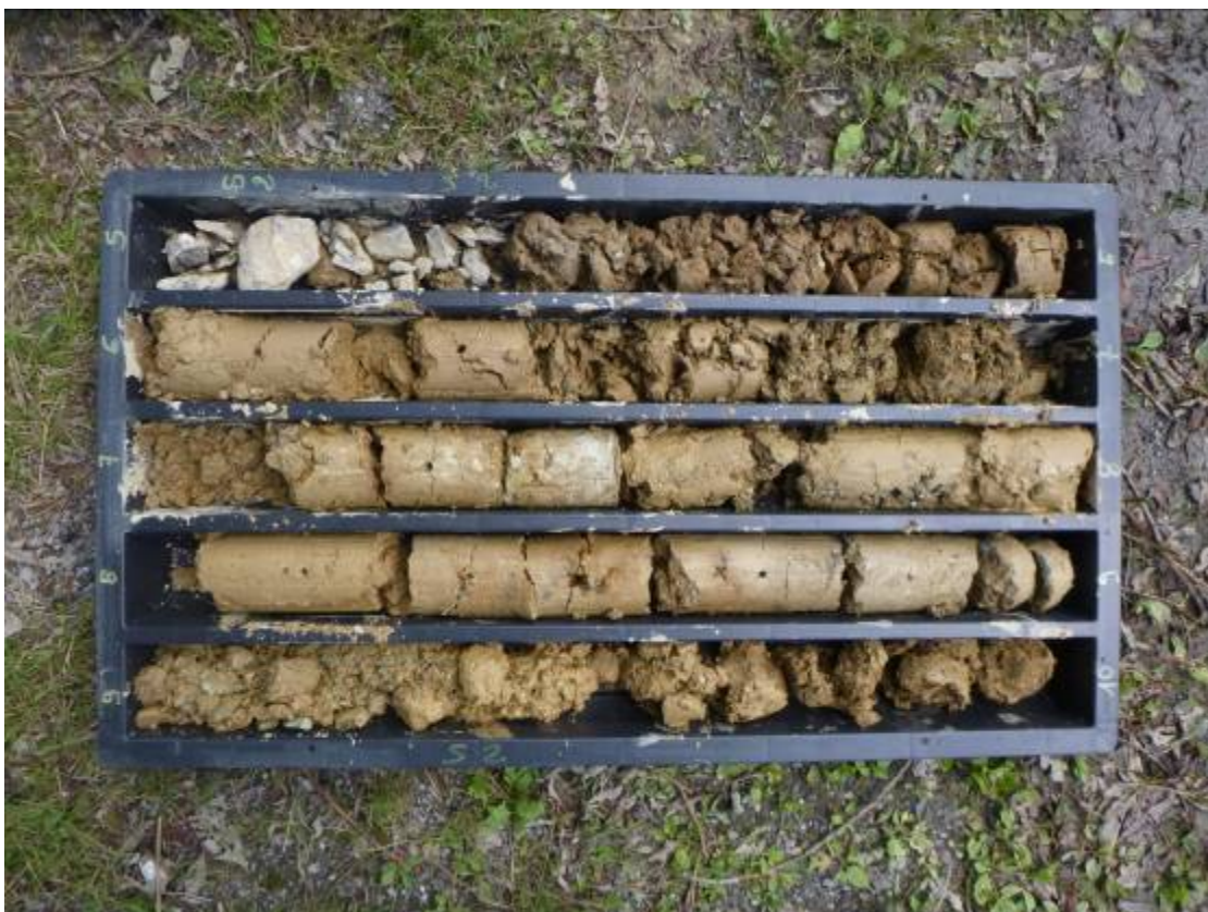
S 2 Carotaggio da -5.00 a -10.00 m dal p.c.
