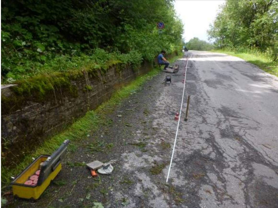
Stendimento di 24 geofoni via Valzelli
