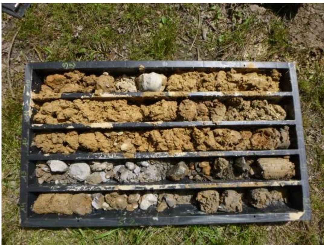
S 2 Carotaggio da -10.00 a -15.00 m dal p.c.
