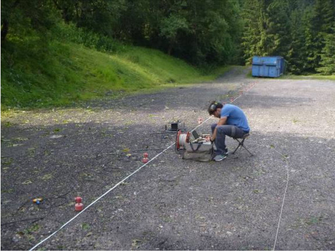
Stendimento di 24 geofoni sul parcheggio P2
